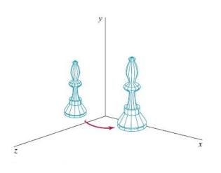
$$\begin{bmatrix} x' \\ y' \\ z' \end{bmatrix} = \begin{bmatrix} \cos \theta & 0 & \sin \theta & 0 \\ 0 & 1 & 0 & 0 \\ -\sin \theta & 0 & \cos \theta & 0 \\ 0 & 0 & 0 & 1 \end{bmatrix} \begin{bmatrix} x \\ y \\ z \\ 1 \end{bmatrix}$$
