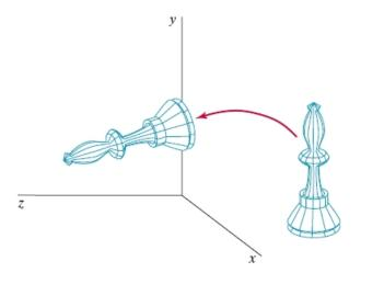
$$\begin{bmatrix} x' \\ y' \\ z' \\ 1 \end{bmatrix} = \begin{bmatrix} 1 & 0 & 0 & 0 \\ 0 & \cos \theta & -\sin \theta & 0 \\ 0 & \sin \theta & \cos \theta & 0 \\ 0 & 0 & 1 \end{bmatrix} \begin{bmatrix} x \\ y \\ z \\ 1 \end{bmatrix}$$
