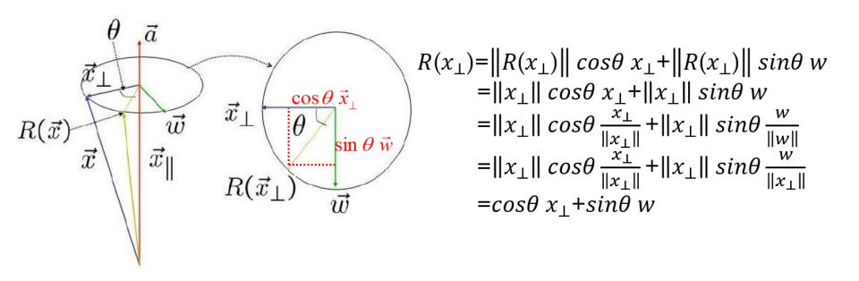
$$\begin{bmatrix} x' \\ y' \\ z' \end{bmatrix} = \begin{pmatrix} \mathbf{Symmetric} \begin{bmatrix} a_x \\ a_y \\ a_z \end{bmatrix} (1 - \cos \theta) + \mathbf{Skew} \begin{bmatrix} a_x \\ a_y \\ a_z \end{bmatrix} \sin \theta + \mathbf{I} \cos \theta \begin{bmatrix} x \\ y \\ z \end{bmatrix}$$
