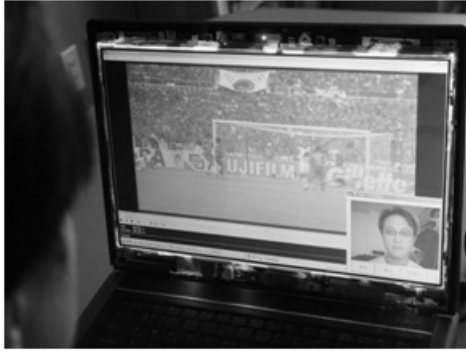
그림 16. 가변형 패럴랙스배리어(parallax barrier)를 이용한 시점 추적형 3D 디스플레이 시스템의 구현.
