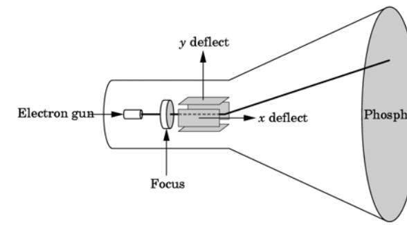
컴퓨터의 출력은 디지털 아날로그 변환기 (digital-to-analog converter)에 의해 x,y (수직, 수평) 편향판 사이의 전압으로 변환. 충분한 양의 전자선이 형광 물질에 도달하면 CRT 표면에서 빛이 방출. CRT는 a line-drawing device (calligraphic)로 사용되거나 프레임 버퍼 (raster mode) 출력에 사용
